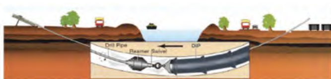
การดึงท่อกลับ (Pipeline-Pullback)
