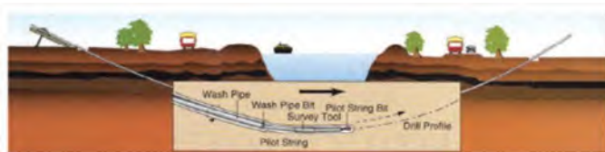
การเจาะนำร่อง (Pilot Hole Drilling)
